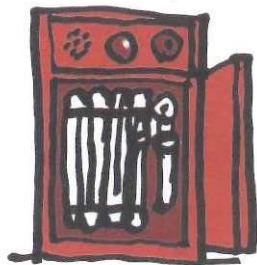
屋内消火栓設備
