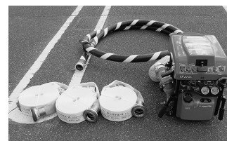
▲可搬式小型動力ポンプ
