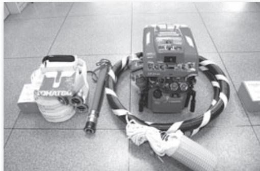
▲可搬式小型動力ポンプ一式
