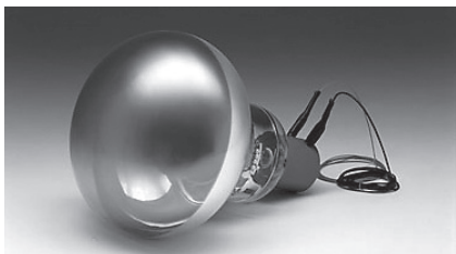
カミオカンデ用 20 インチ光電子増倍管 引用 浜松ホトニクス株式会社ホームページ
