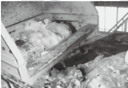
●袋を破る機械でバラバラにします
