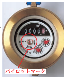
水道メーターを上から見たところ
