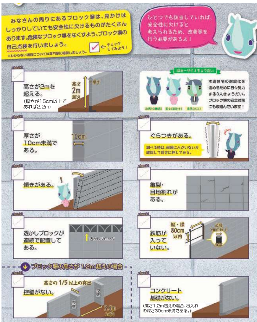
【ブロック塀安全点検票】
