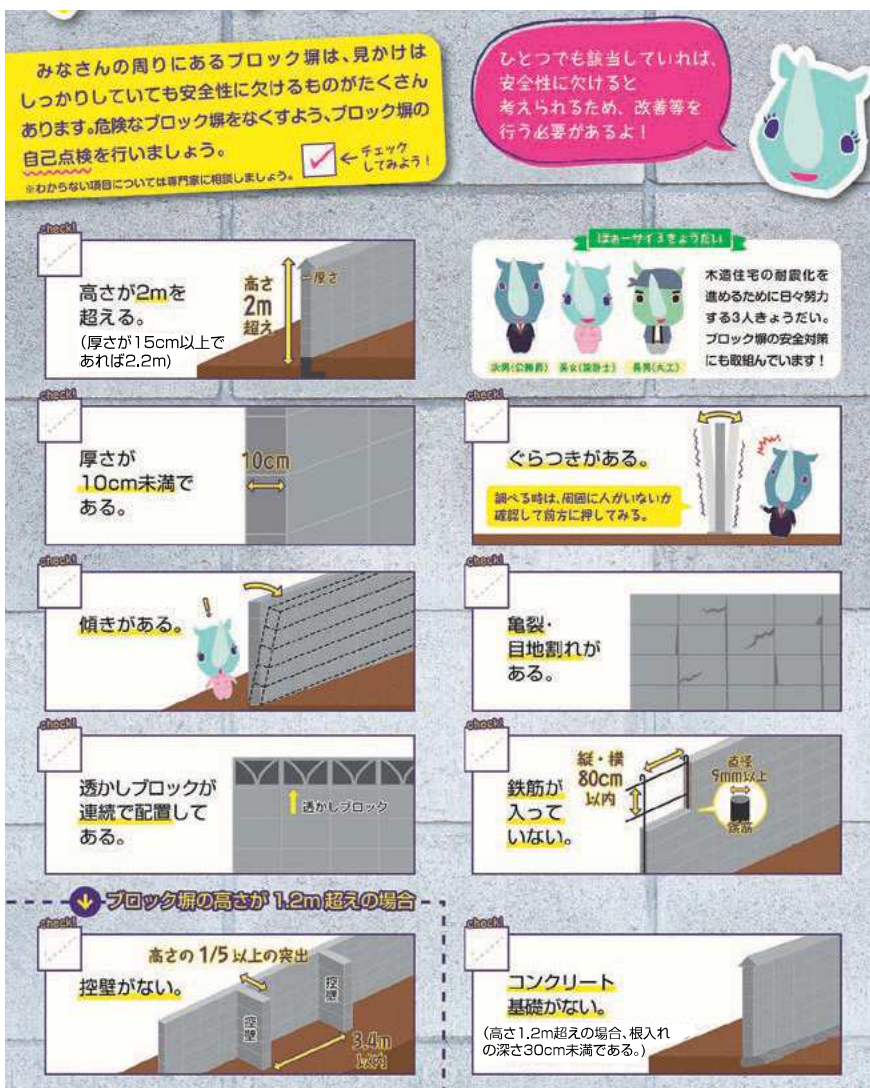
【ブロック塀安全点検票】
