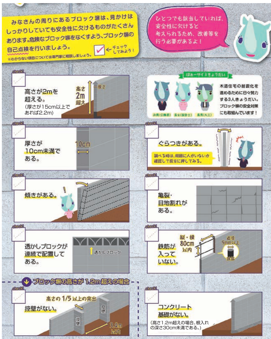
【ブロック塀安全点検票】
