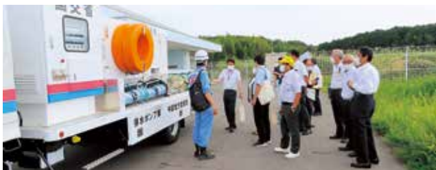
防災ステーションに配備された国交省の排水ポンプ車
